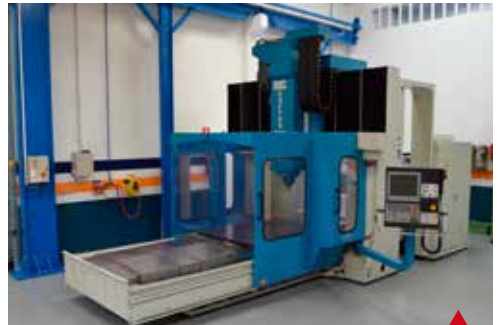
NICOLÁS CORREA FP 30/30 RECONSTRUIDA HEIDENHAIN TNC-530 NUEVO 1.998 Superficie Mesa 3.000 x 1.250 mm Recorridos (X/Y/Z) 2.500/2.000/1.000 mm
