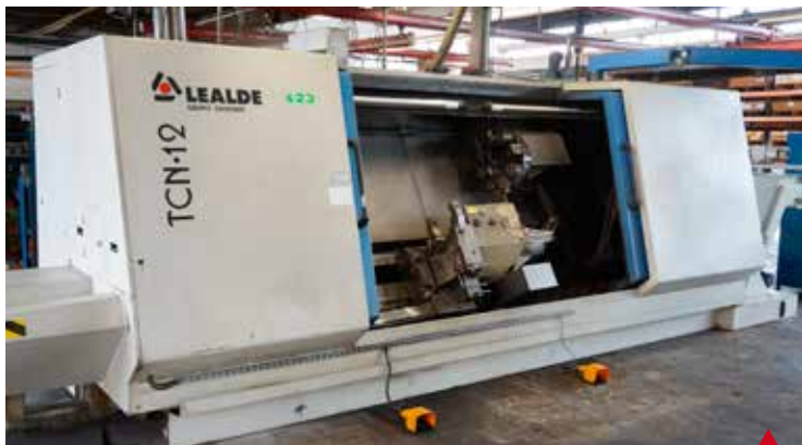
LEALDE TCN-12 x 2500 FANUC 21i (2.003) Distancia entre ptos 2,500 mm Diámetro máx. mecanizable 720 mm. Evacuador de Viruta
