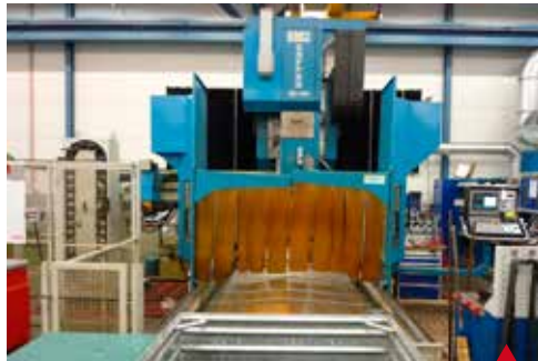
NICOLÁS CORREA FP 30/30 ATC HEIDENHAIN TNC-426 (2.000) Sup. Mesa 3.000 x 1.250 mm Paso entre columnas 1.740 mm Rec. (X/Y/Z) 2.500/2.000/1.000 mm. R. I. Cargador 30 Htas.
