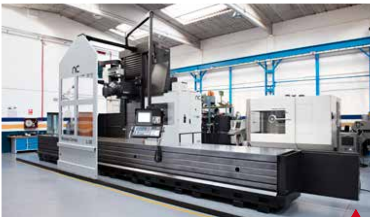
NICOLÁS CORREA L30/104 RECONSTRUIDA HEIDENHAIN TNC 426 (1998) Cabezal Automático 2.5°/2.5° Sup. Mesa 12.240 x 1.000 mm Recorridos (X/Y/Z) 10.450/11.200/2.000 mm. ATC 30 Hts. Evacuador de Viruta. R.I.
