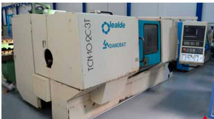
LEALDE TCN10 2C 3T SIEMENS 840 (1.996) Recorridos X (1/2/3) 175/175/150 mm Recorridos Z (1/2/3) 300/950/950 mm Cargador de Barras LNS HYDROBAR. Evacuador de Virutas.
