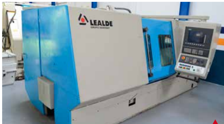
LEALDE TCN-10 2C 2T SIEMENS 840 (1.994) Recorridos X (1/2) 250/250 mm Recorridos Z (1/2) 310/750 mm Recogedor de Piezas
