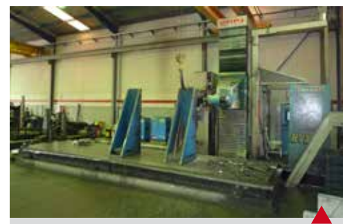
ANAYAK HVM-8000 SIEMENS 840 (2.002) Cabezal Automático 2,5° / 2,5° Superficie Mesa 8.000 x 2.000 mm Recorridos (X/Y/Z) 7.300 / 1.500 / 2.500 mm Cargador 40 Hts.
