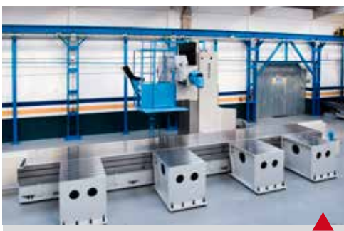
ZAYER 30 KM-10.000 RECONSTRUIDA 2.014 HEIDENHAIN TNC-530 (2.000) Cabezal Giro Autom. 0,001° - 2x180°. 3.000 r.p.m. Sup. Mesa 9.700 x 1.200 mm Recorridos (X/Y/Z) 8.400/1.250/2.000 mm
