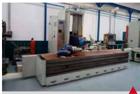
NICOLÁS CORREA L30/28 FAGOR 8055 MC (1.994) Cabezal Automático 2,5° / 2,5° Cabezal Sal. Direc. Sup. Mesa 4.590 x 1.000 mm Recorridos (X/Y/Z) 2.800/1.200/1.500 mm
