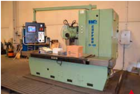
NICOLÁS CORREA A16 HEIDENHAIN TNC 415 (1.993) Superficie Mesa 2.000 x 630 mm Recorridos (X/Y/Z) 1.800 / 800 / 800 mm Amarre Hidráulico de Herramientas
