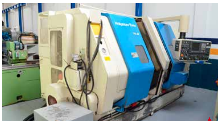
NAKAMURA TW-20 MMY FANUC 18 TB (1.996) Recorridos (X1/x2/Z1/Z2) 195/195/265/780 mm EJE C. Herramientas Motorizadas. Eje Y. Evacuador de Virutas.
