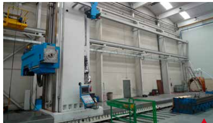
CME MQ-12.000 HEIDENHAIN TNC 530 NUEVA 2.014 Cabezal Automático 1° / 1° Recorridos (X/Y/Z/ W) 12.000 / 1.200 / 4.000 / 700 mm Cargador 120 Herramientas. Evacuador de Viruta. Refrigeración Interna.
