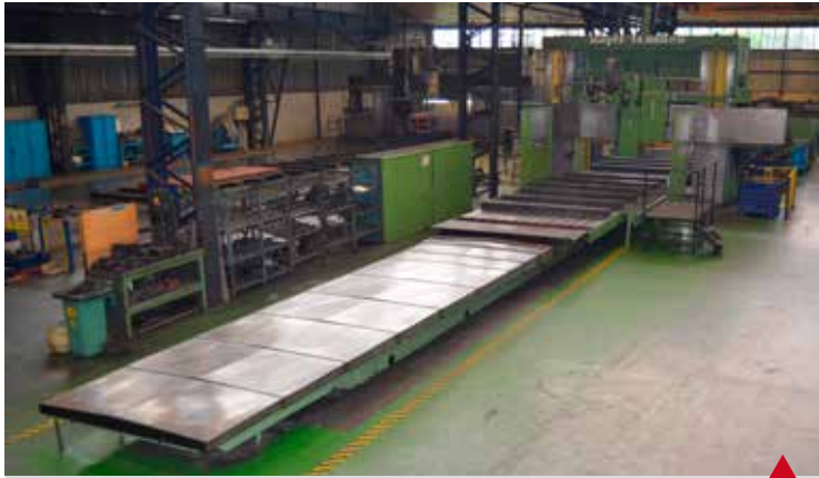
ZAYER FMU 1400 HEIDENHAIN TNC 530 (NUEVO) 1.990 - Superficie Mesa 14.000 x 2.500 mm Recorridos (X/Y/Z) 14.000 / 6.800 / 3.710 mm Paso entre Columnas 3.100 mm Amarre Hidráulico de Herramientas
