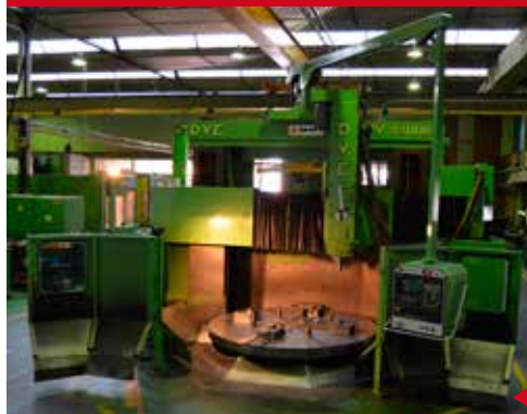
TORNO CNC DYE-BOST TV 2300 R SIEMENS 840 (1.996) RECONSTRUIDO 2.012 Diámetro Plato 2300 mm Diámetro Máx. Torneable 2.300 mm Altura máxima de Torneado debajo del travesaño 1.500 mm Amarre Hidráulico de Herramientas
