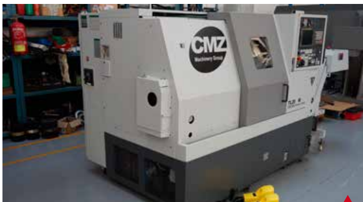
CMZ TL 20M FANUC 21i - TB (2.006) Diámetro Máx. Torneable 400 mm Recorridos (X/Z) 240 / 640 mm Paso de Barra 66 mm Eje C. Herramientas Motorizadas.
