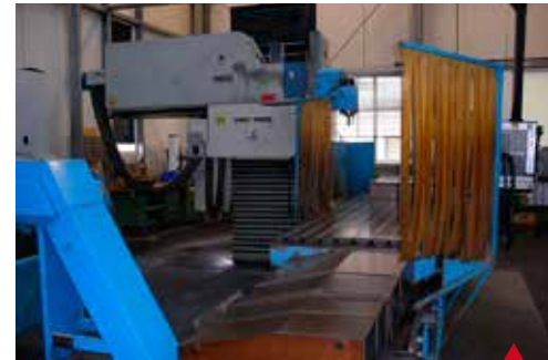
ZAYER 30 KF-4000 HEIDENHAIN TNC-430 PA. (1998) Cabezal Automático 0,001° / 0,001° Superficie Mesa 4.000 x 1.300 mm Recorridos (X/Y/Z) 3.720 / 1.513 / 1.500 mm
