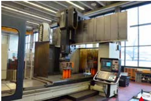
NICOLÁS CORREA FP40/40 S ATC UDG HEIDENHAIN TNC 426 PA (1997) Sup Mesa 4.000 x 1.250 mm Rec. (X/Y/Z) 4.000/3.000/1.000 mm Cabezal Ortogonal 2.5°/2.5°. Cargador 60 Htas.
