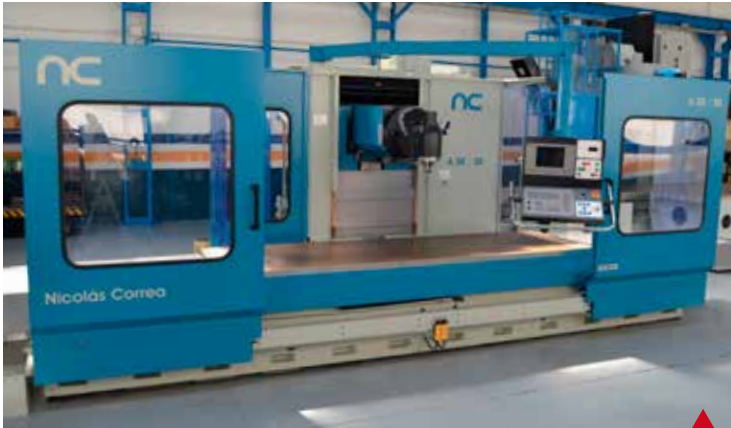
NICOLÁS CORREA A 30/30 UDG RECONSTRUIDA CNC HEIDENHAIN TNC 426 D (1998) Cabezal Automático 2.5° / 2.5° Superficie Mesa 3.000 x 1.100 mm Recorridos (X/Y/Z) 3.000 / 1.200 / 1.000 mm
