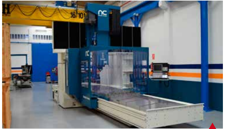
NICOLÁS CORREA FP40/40 RECONSTRUIDA HEIDENHAIN TNC 530 (NUEVO) 1.996 - Sup. Mesa 4.000 x 1.250 mm Recorridos (X/Y/Z) 3.500/2.500/1.000 mm Distancia entre columnas 2.040 mm 2 Cabezas Salida Directa y 45°
