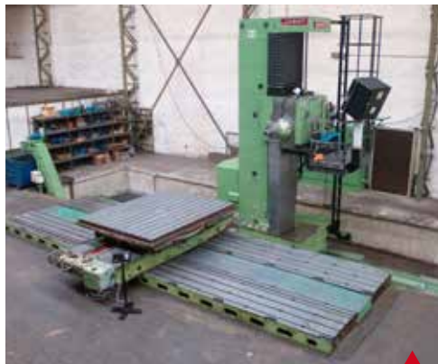
JUARISTI MDR-150 CM FAGOR 8050 (1.999) Sup. Mesa Soltere 8.000x2.600 mm Rec. (X/Y/W) : 8.000/3.000/500 m. Evacuador Vitura Longitudinal
