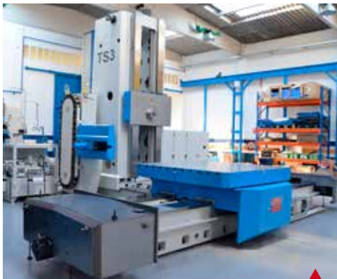
JUARISTIS3 5EJES HEIDENHAIN TCN 426 (2001) Sup. Mesa 2.000 x 2.000 mm Rec. (X/Y/Z) 4.000/2.500/1.925 mm. Cargador 40 Htas. Evacuador Viruta. Refrigeración Interna y Externa
