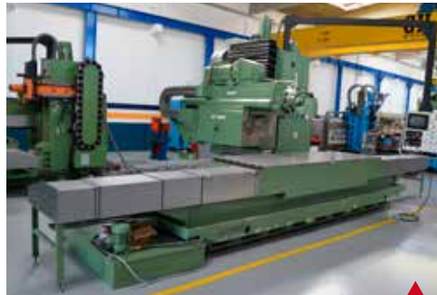
ZAYER KF-3000 HEIDENHAIN TNC 355 (1.991) Superficie Mesa 3.000 x 1.000 mm Recorridos (X/Y/Z) 2.700 / 1.250 / 1.000 mm Cono Cabezal/Taper ISO 50
