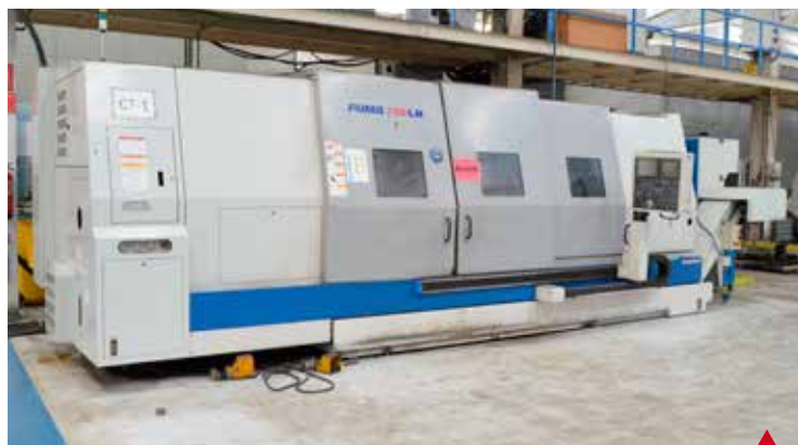
DOOSAN PUMA 700 LM X 3000 FANUC 181 TB (2.004) Medidor Htas. Extractor Viruta Long. Htas Motorizadas Lunetas SMW 45-350 y 190-450. Plato Hidráulico Ø 600mm. Preparación para Luneta hidráulica.
