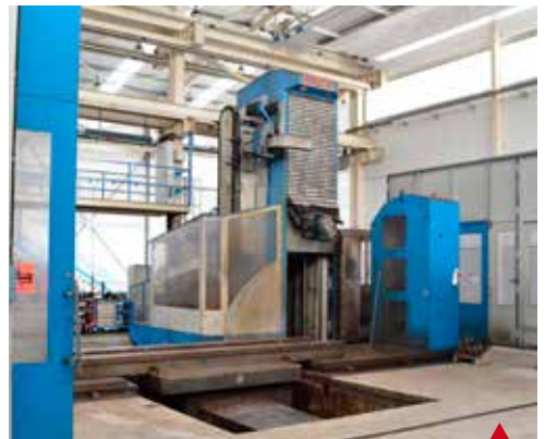
JUARISTI MX7 RAM 10000. Siemens 840D (2004) Recorridos(X/Y/Z) 10.000/4.000/1.500 mm Cabezal Automático 10/10. Ref. Int y Ext. Mesa Giratoria 2.500x2.500 mm. Cargador 80 Htas
