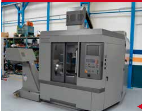
IBARMIA ZV-25/U600 5Ejes HEIDENHAIN iTNC - 530 (2.002) Recorridos (X/Y/Z) 600/428/410 mm Curso Eje A +120°-120°/min. 0,001° Curso Eje C 360°/min. 001° Dimensión Mesa Ø 400 Refrigeración Interna Evacuador de Viruta
